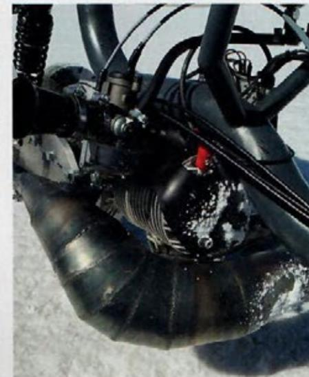
Der Rahmen für die Bonneville-Lami stammt aus einer 1962er Li3 150, beim Zylinder handelt es sich um einen Monza 225, der Auspuff ist eine Eigenanfertigung eines Bekannten.
